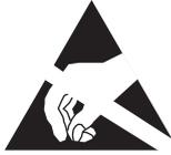
请注意：B426-CN 板无防静电包装，板上所有部件可被手指触碰到，因此须格外注意防静电措施。确保使用板时无静电干扰。必须采取适当的防静电措施，并建议做好静电防护，如配戴防静电腕带。静电损害轻则设备细微的性能下降，重则整个设备故障。
