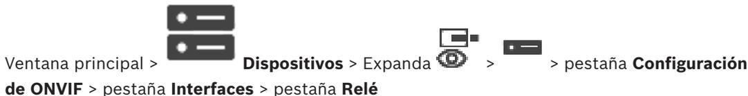
El estado de inactividad física de una salida de relé puede configurarse estableciendo el estado de inactividad a **abierto** o **cerrado** (inversión del comportamiento del relé).
