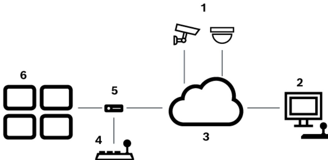
**Abbildung 5.2:** Szenario 2: An einen Decoder angeschlossenes Bosch IntuiKey Keyboard
