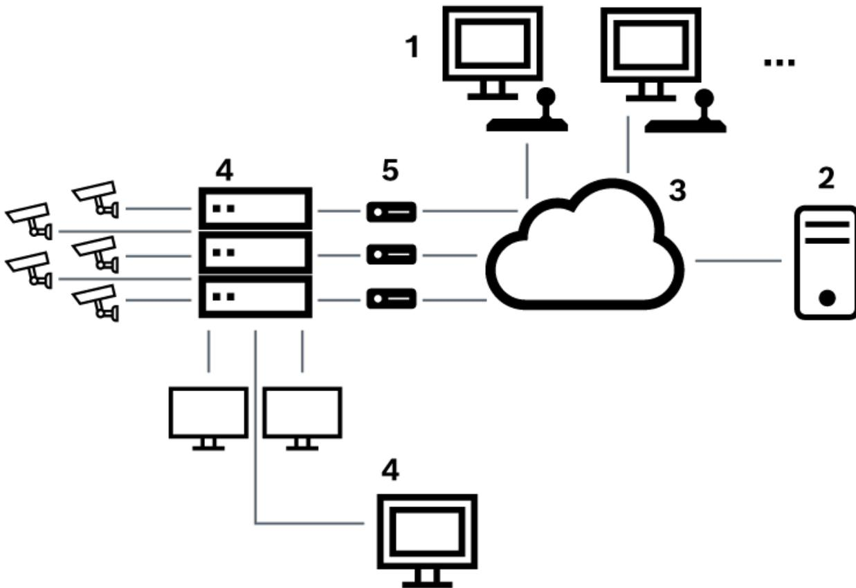
**Abbildung 5.4:** Entfernte Verbindung des Bosch Video Management System mit einem Bosch Allegiant-Matrix-Switch
