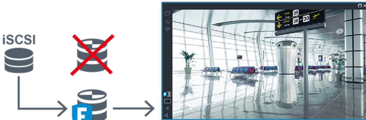
Sind sowohl der Primäre VRM als auch der optionale Primäre Failover-VRM nicht angeschlossen, ist eine Wiedergabe über den Encoder möglich. Schließen Sie das Bildfenster und lassen Sie sich die Kamera erneut in einem Bildfenster anzeigen:
