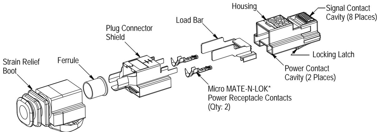
**SHIELDED OR UNSHIELDED 10-CONDUCTOR COPPER CABLE**
