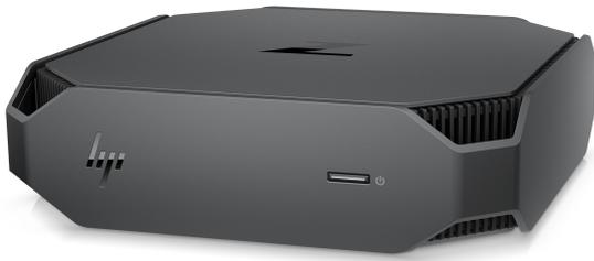
Il server di sistema DICENTIS utilizza la microarchitettura Intel di nuova generazione e il sistema operativo Microsoft Windows Telecommunications Server per offrire prestazioni e stabilità elevate per le applicazioni per conferenze.
