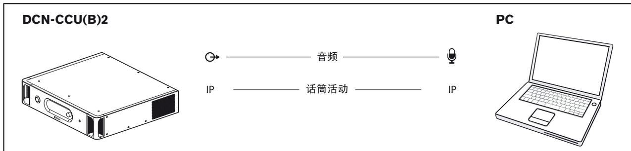
图 1.4: 连接到 DCN-CCU(B)2 系统
