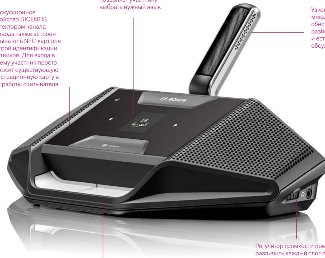
Кнопка(и) микрофона обеспечивают интуитивно понятное использование в режиме двух пользователей или для выполнения функций председателя
