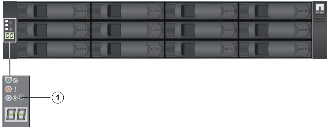
1 Knop voor het operatordisplaypaneel (ODP)
