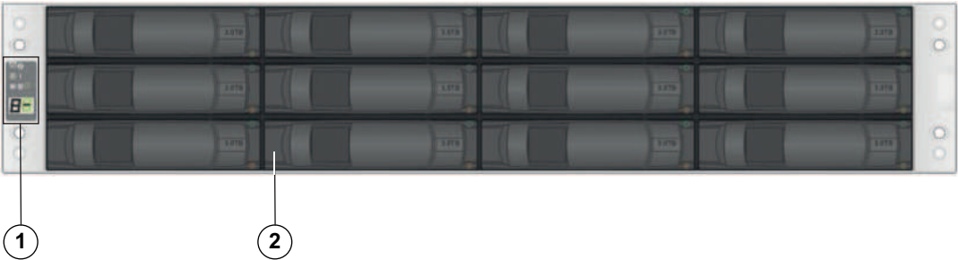
12盘位控制器单元或扩展单元 - 前视图 (单控制器单元、双控制器单元或扩展单元的前视图)
