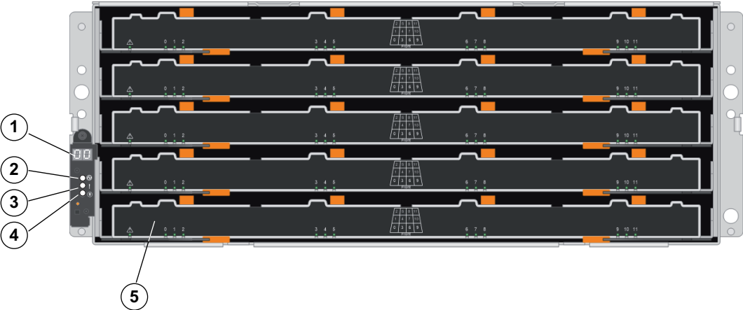
Unità di espansione o unità di controllo doppia a 60 alloggiamenti, vista anteriore
