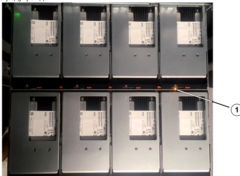
1 — горящий индикатор предупреждения диска справа сверху.
