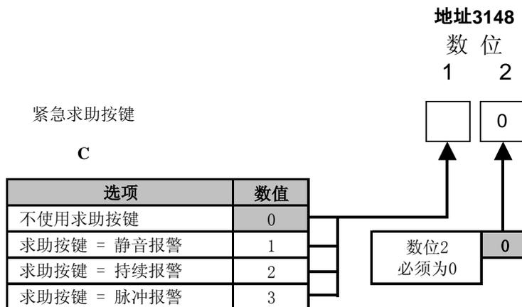
**步骤 6：主机板上的输出的编程(对于遥控器 RF3334)：编程地址 2734-2736（可选）**
