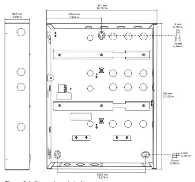
Figure 2.1: Dimensions du boîtier
