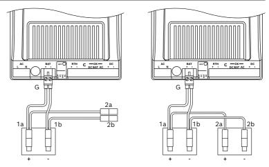
Figure 3.3: Mode 12 V - avec une batterie (à gauche) : mode 12 V avec deux batteries (à droite)
