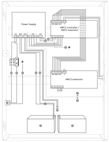
Figure 3.1: Connexions dans le boîtier
