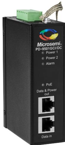
El midspan PoE para aplicaciones industriales permite utilizar alimentación PoE remota para diversas cámaras IP de Bosch. El midspan PoE genera un máximo de 60 W y cumple con el estándar IEEE 802.3at PoE y es compatible con IEEE 802.3af. El modelo industrial también cuenta con dos características clave:
