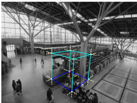
**Nota:** el cubo se ha calculado a partir de las direcciones principales de las estructuras rectas detectadas en la imagen.
