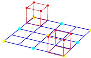
El plano virtual aparece en forma de una cuadrícula azul que se puede inclinar, rotar y ajustar. Sitúe el plano virtual en la imagen de la cámara de manera que coincida con el ángulo y la perspectiva de una de las áreas horizontales reales. La sección de una calle es un área de referencia adecuada, especialmente si ambos lados de la calle están seleccionados.
