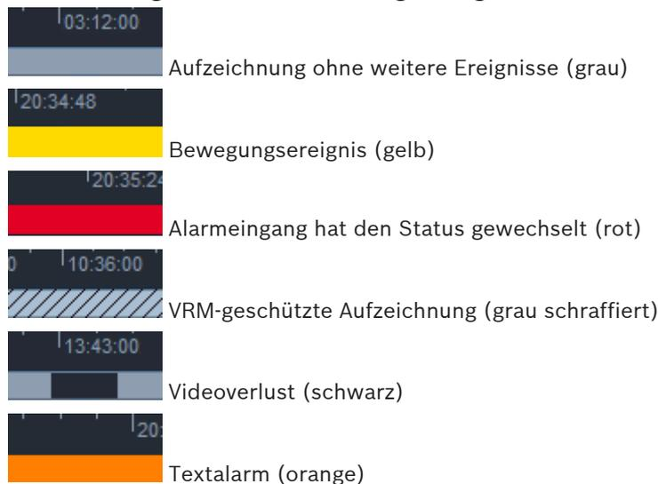
Bei einigen Ereignissen von mit Divar 700 verbundenen Kameras ist nur die untere Hälfte der Anzeige farbig:
